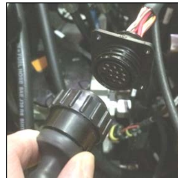
Расположение и внешний вид точки подсоединения устройства аварийного управления
