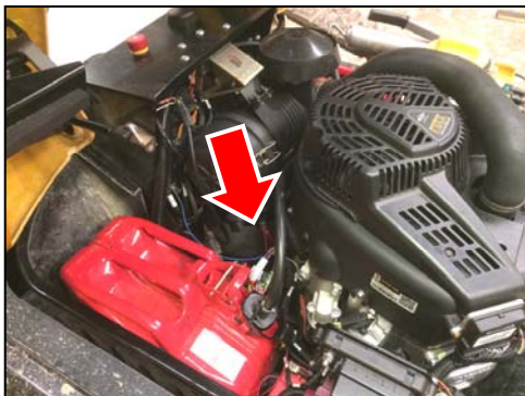
Расположение и внешний вид точки подсоединения устройства аварийного управления
