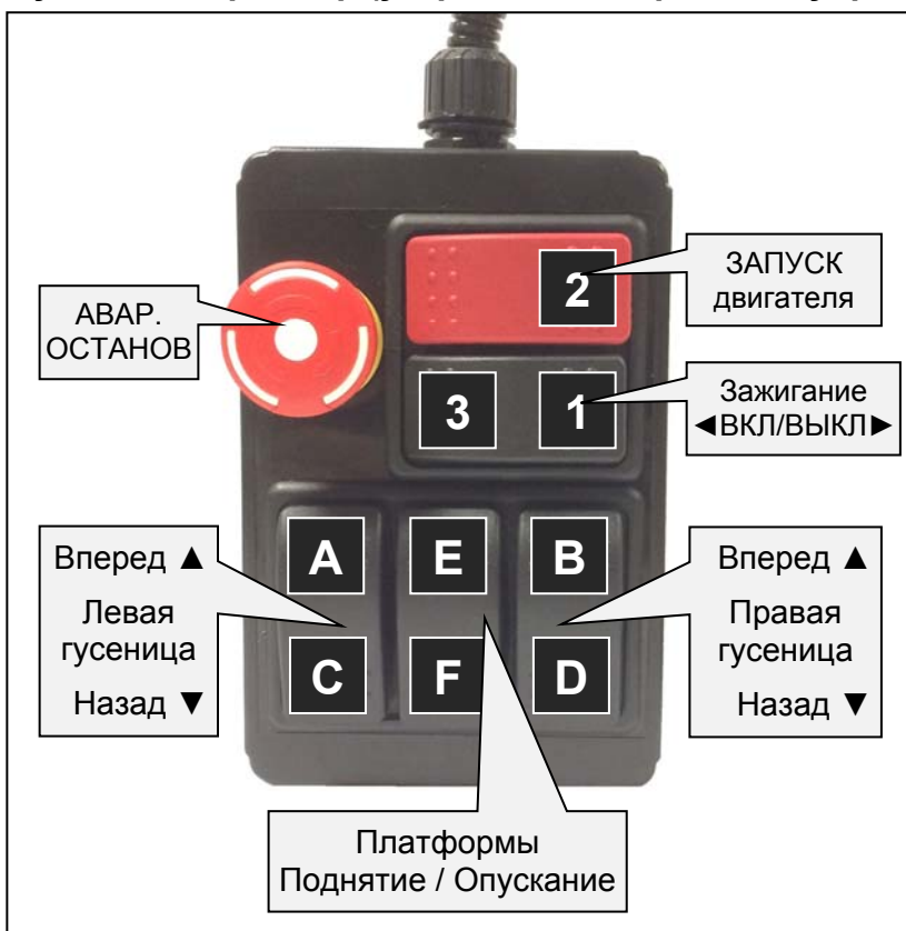
Расположение и внешний вид точки подсоединения устройства аварийного управления
