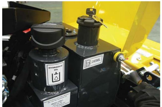
Lösen Sie zum Betanken den Deckel des Kraftstofftanks (a) und tanken Sie nach; füllen Sie den Tank nicht bis an die Oberkante, sondern lassen Sie etwas Raum zum Ausdehnen. Schließen Sie den Deckel und schließen Sie mit dem Schlüssel ab.
