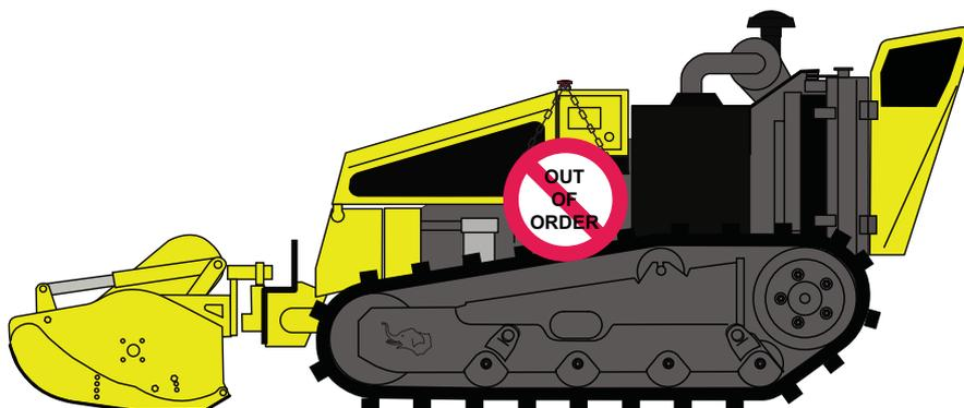
Bringen Sie ein Schild „AUSSER BETRIEB“ an der Einheit an. Ziehen Sie den Schlüssel vom Armaturenbrett ab, bevor Sie mit der Wartung beginnen.
