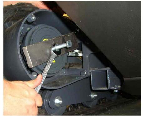
3 - Mit Hilfe einer gelochten Platte, in einer Schraube M12 Schraube aus in die Gewindebohrung des Motors bis zum Anschlag. Mit einer Mutter M12, langsam schrauben, bis die Bremse gelöst wird.
