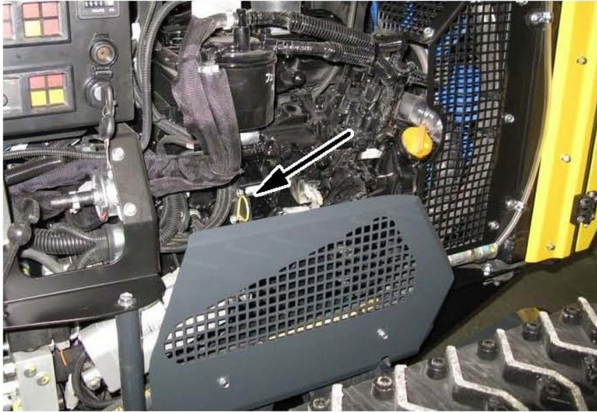
Bild 1. Ölmesstab von Motor
