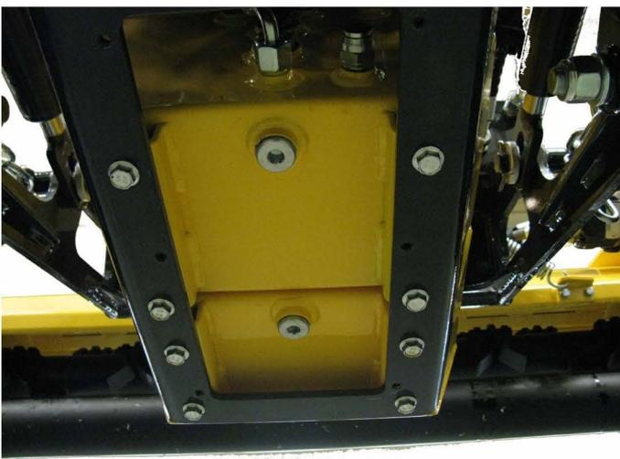
Bild 7: Boden vom Öl- und Dieseltank
