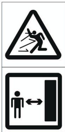
Warnen Sie von möglicher Schleudergefahr von Fremdkörpern, hervorgerufen durch rotierende Teile an der Maschine. Bitte einen Sicherheitsabstand zur Maschine einhalten.
