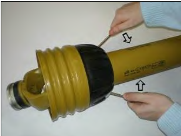
Klappen hochwuchten um den Schutz zu lösen
