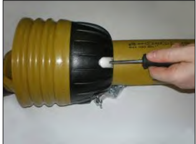
Schieben Sie Schraubenzieher in die Klappen
