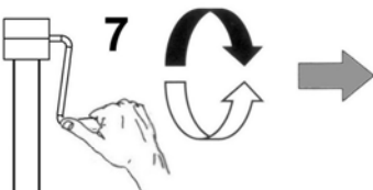
7 Maschine auf ihren Stützen soweit absenken, dass sich die Sicherungsbolzen aller Platten in einer Linie befinden, die gewährleistet, dass sich die oberen Laschen der Maschine oben an der DIN-Platte einsetzen lassen
