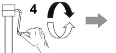
4 Anheben der Maschine auf den Stützen bis zu einer Höhe, bei der die DIN-Befestigungslaschen höher sind als die DIN-Platte des Fahrzeugs
