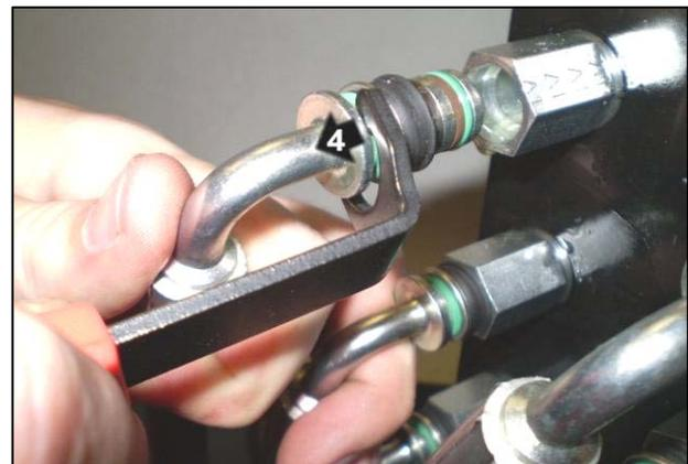
(3) Betätigen Sie das Werkzeug nach außen und lösen Sie das Anschlussstück (rückwärts)
