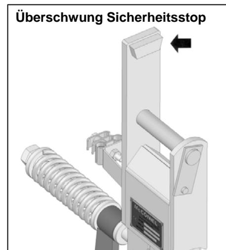
kompletten Armkopf und Rahmen nach oben zu und hinten zu schwenken bis das Hindernis umgangen ist oder der Traktor zum Stillstand gebracht wird.
