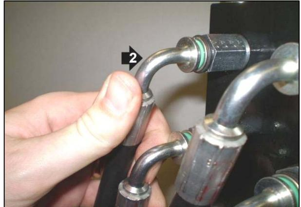
Anbauen: (1) Platzieren Sie das Schlauchende in die Gegenstelle. (2) Drücken Sie das Schlauchende in Position und ziehen sie zur Überprüfung daran.
