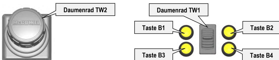
Mini Joystick: Hebel-, Daumenrad- und Tastenfunktionen
