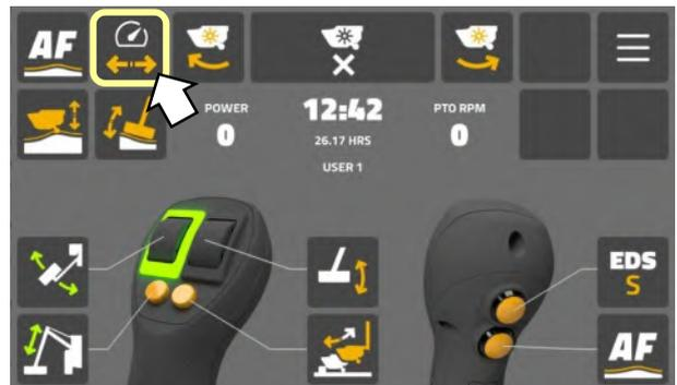
Das ausgewählte **„Steuerungssymbol“** wird auf dem Bildschirm angezeigt und das Symbol steuert nun diese Funktion.
