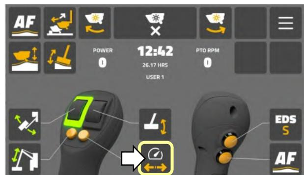
Das ausgewählte „**Steuerungssymbol**“ wird auf dem Bildschirm angezeigt und die Taste steuert nun diese Funktion.
