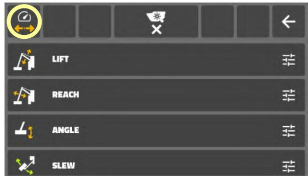
Das System verfügt über zwei unabhängige Ventilmodi, die vom Benutzer an unterschiedliche Arbeitsaufgaben angepasst werden können. Benutzer können über das Symbol „**Ventilmodus**“ zwischen den Modi wechseln.
