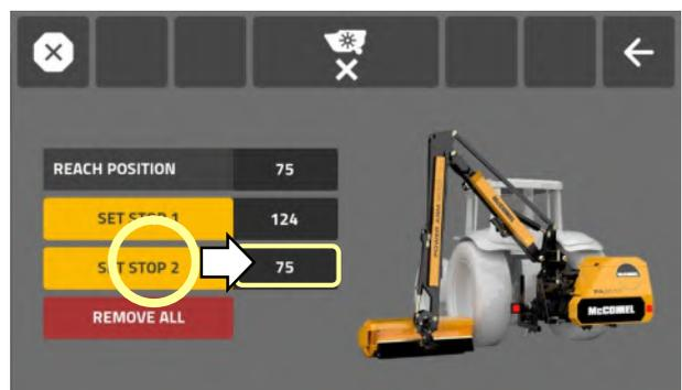
Avec le bras arrêté à la « position d'arrêt » requise, sélectionnez le panneau « **définir l'arrêt 2** » pour enregistrer ce point d'arrêt.
