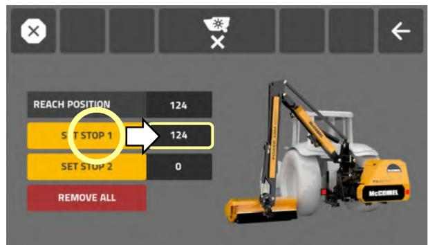
Avec le bras arrêté à la « position d'arrêt » requise, sélectionnez le panneau « **définir l'arrêt 1** » pour enregistrer ce point d'arrêt.
