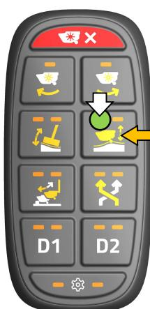
Joystick-Tasten Einstellung des Schwimmerdrucks
