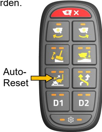
Die äußerste LED am Einschalten der Taste leuchtet dauerhaft grün, um anzuzeigen, dass die automatische Rücksetzung aktiviert ist.
