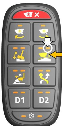
Die rechte LED-Anzeige leuchtet statisch GRÜN, um anzuzeigen, dass die Standard-Hebenschwimmer eingeschaltet und AKTIV ist.
