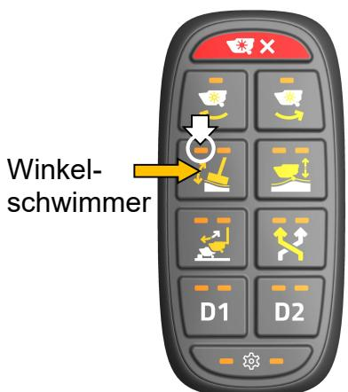
Die linke LED am Einschaltknopf leuchtet statisch GRÜN, um anzuzeigen, dass die Winkelschwimmer eingeschaltet und AKTIV ist.
