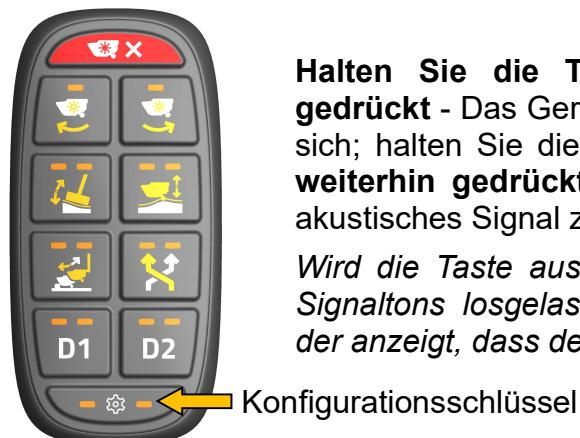
**Halten Sie die Taste „Konfiguration“ 20-30 Sekunden lang gedrückt** - Das Gerät gibt 5 Sekunden lang einen langen Piepton von sich; halten Sie die Taste weiterhin gedrückt, **Halten Sie die Taste weiterhin gedrückt**; Wenn der Reset abgeschlossen ist, ertönt ein akustisches Signal zur Bestätigung des erfolgreichen Resets.
