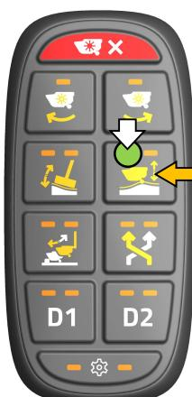
Les boutons du joystick permettent de régler la pression du flotteur de levage
