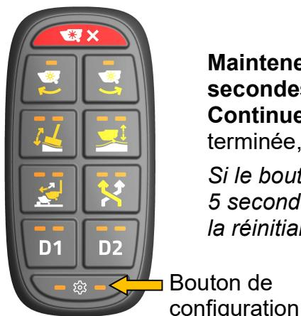
**Maintenez le bouton « Configuration » enfoncé pendant 20 à 30 secondes**; l'appareil émet un bip long pendant 5 secondes. **Continuez à maintenir le bouton enfoncé**; une fois la réinitialisation terminée, un signal sonore confirme la réussite de l'opération.
