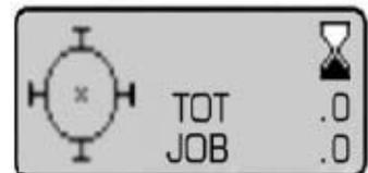
3. Durch Drücken einer der 'Rotor Ein'-Tasten wird das Eieruhrsymbol aktiviert und der Rotor im Bild angezeigt.
