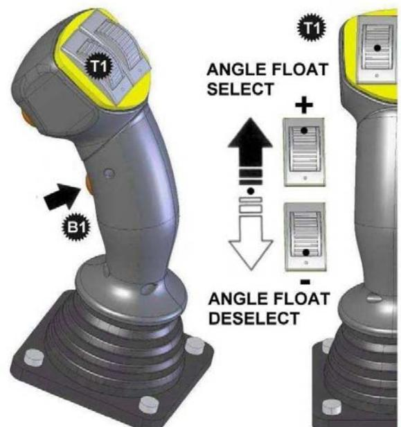
**HINWEIS:** Beim Auswählen oder Aufheben der Auswahl der Funktion sollte das Daumenrad (T1) zurück in seine mittlere Position zurückkehren können, bevor die untere vordere Taste (B1) losgelassen wird.
