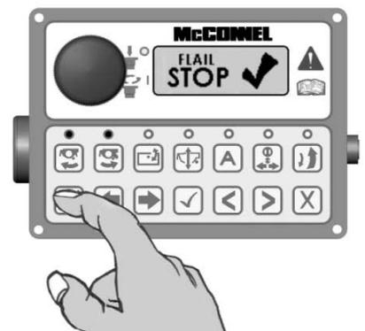
**WARNUNG:** Wenn die LED-Leuchte aus geht, bedeutet dies nicht, dass der Rotor sich nicht mehr dreht, es bedeutet nur, dass der Ölfluss zum Rotor ausreichend gestoppt wurde, sodass die Rotationsrichtung geändert werden kann. Deshalb muss beim Stoppen eines Rrotors beachtet werden, dass er beträchtlich he Zeit im Freilauf weiterläuft, nachdem die Stopptaste aktiviert wurde. Dies kann in einieen Fällen bis zu 40 Sekunden dauern.
