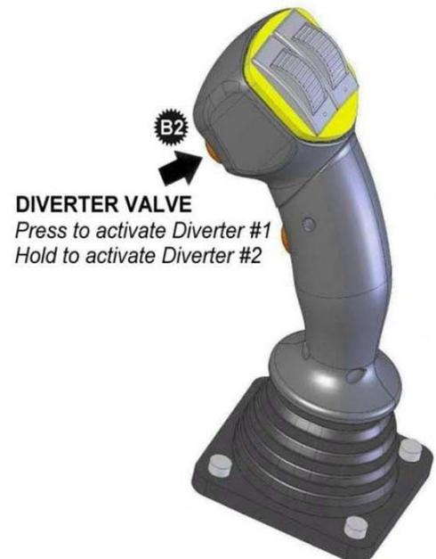
2. Kurzes Drücken der oberen vorderen Taste (B2) am Joystick wählt das Umleitventil Nr.1 – wenn aktiviert, gibt die Steuereinheit einen einzelnen Piepton ab, die LED-Lampe |Bildschirm zeigt kurz 'DIVERTER ON ✓' an.
