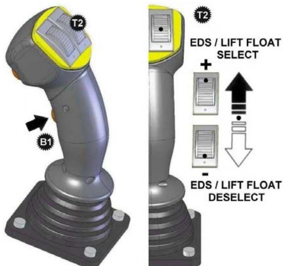
**HINWEIS:** Beim Auswählen oder Aufheben der Auswahl der Funktion sollte das Daumenrad (T2) zurück in seine mittlere Position gehen können, bevor die untere vordere Taste (B1) losgelassen wird.
