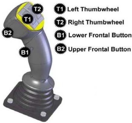
**HINWEIS:** Standardmäßig aktiviert die Betätigung der Daumenräder T1 und T2 in Verbindung mit Taste B1 die Neigung der Schwimmstellung bzw. EDS/Heben der Schwimmstellung. Diese Steuerungen können bei Bedarf, getauscht werden, sodass das Daumenrad die entgegengesetzten Funktionen aktiviert – dieses Verfahren wird durch Aufrufen des Einstellungsmenüs an der Steuereinheit über den Bildschirm und die Menütastenn durchgeführt.
