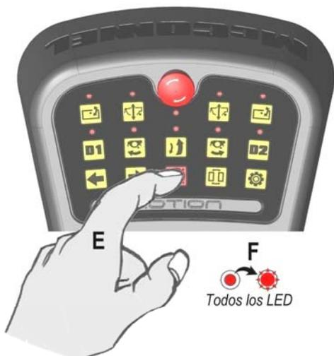
Pulse y suelte el botón de parada de rotor para entrar en el modo de calibración; todos los indicadores LED se encienden intermitentemente al mismo tiempo para confirmar.
