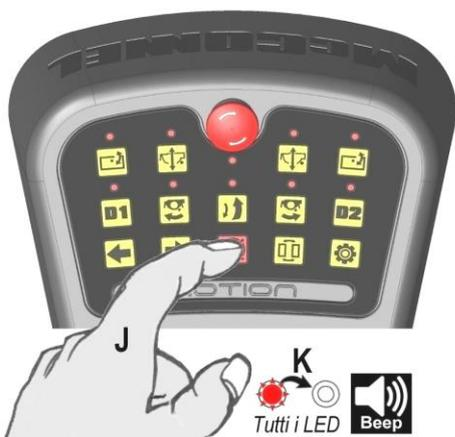
Premere il pulsante di arresto rotore una volta per uscire dalla modalità di calibrazione; tutti i LED lampeggeranno rapidamente e l'unità emetterà un segnale acustico di conferma.
