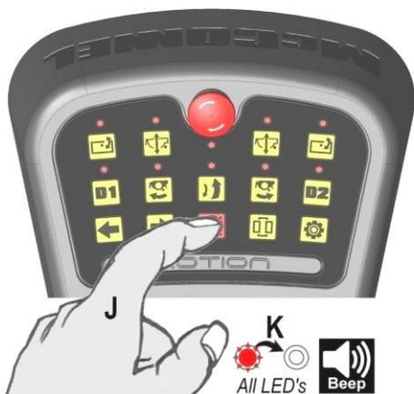
Appuyer une fois sur le bouton d'arrêt du rotor pour sortir du mode d'étalonnage ; tous les voyants DEL clignotent rapidement et l'unité émet une tonalité de confirmation.
