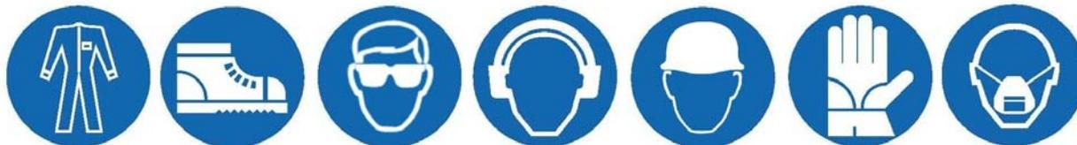
Es wird empfohlen, die folgende Schutzausrüstung getragen wird beim Betrieb und / oder Wartung dieser Maschine; Overalls, Sicherheitsschuhe, Schutzbrille, Gehörschutz, Sicherheitshelm, Schutzhandschuhen, respiratory Schutz.
