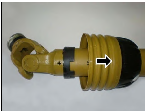
Varovalo potisnite nazaj do univerzalnega zgloba.
