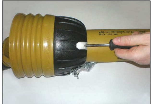
Вставить отвертки в фиксаторы
