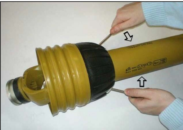
Сместить фиксаторы для снятия кожуха
