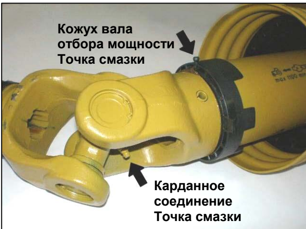
Местоположение точек смазки
