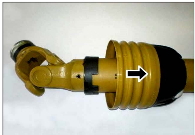
Сдвинуть кожух назад для открывания карданного соединения
