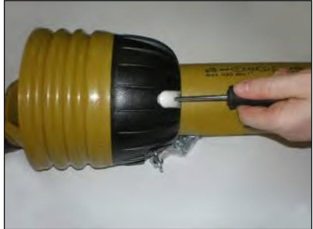
Schieben Sie Schraubenzieher in die Klappen
