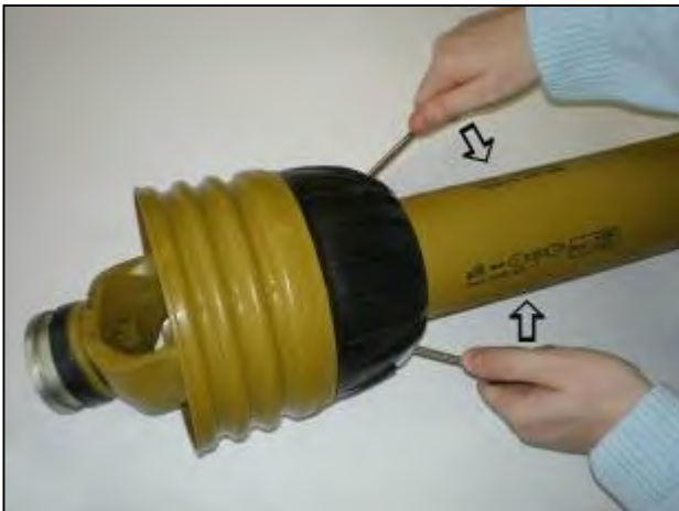
Klappen hochwuchten um den Schutz zu lösen
