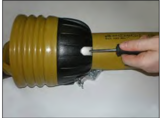
Schieben Sie Schraubenzieher in die Klappen
