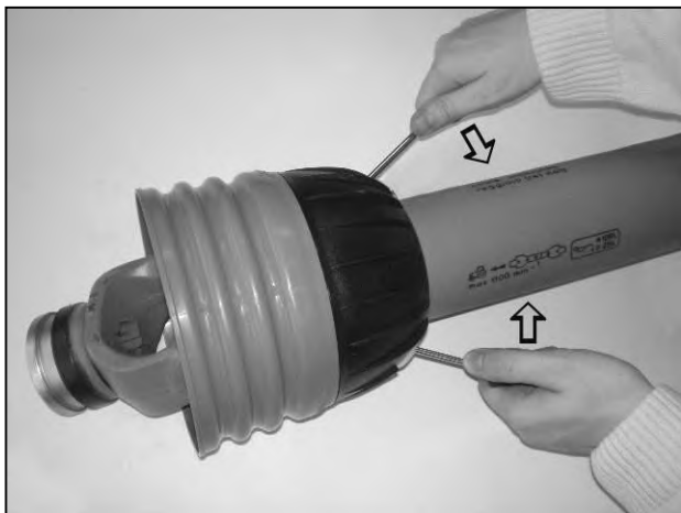
Ouvrez les fermoires pour dégager la protection
