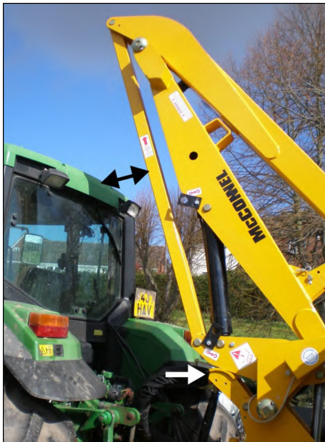
Maschine in Transportposition ► Kipper in Kontakt mit dem Kabinenschutzhalterung.
