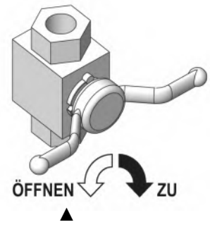
HAHN TYP SCHWENK- SPERRUNG auf – nur zum Arbeiten zu – immer für Transport und Lagerung
