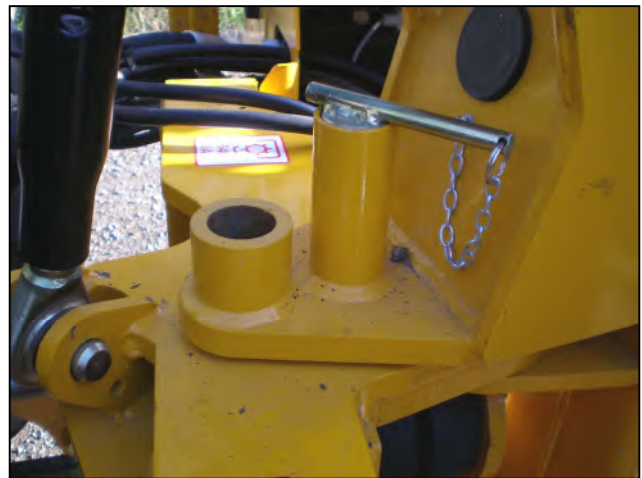
Schwenken entsperrt – nur zum Arbeiten
