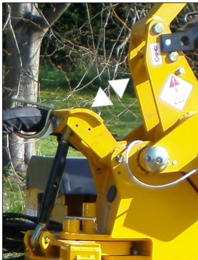
Stellen Sie sicher, dass der Kipper ► Abstand zur Kabinenschutzhalterung hat, bevor der Arm geschwenkt wird.
