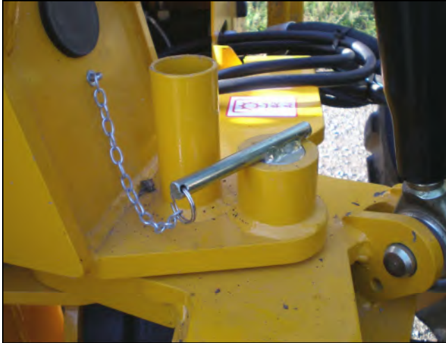
Epingle en position de transport & stockage
