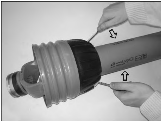
Ouvrez les fermoirs pour dégager la protection
