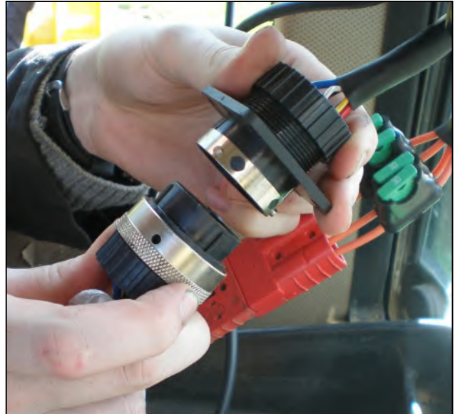
Verbind de lijnen om de machines besturingseenheid in de cabine.
