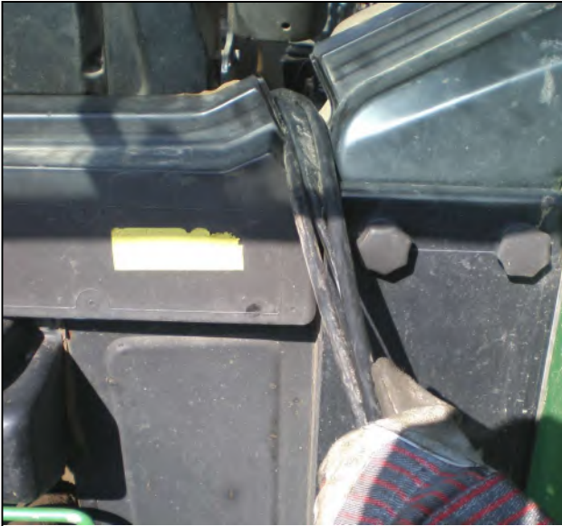
Installeer de lijnen in cabine - vermijd scherpe bochten en houd lijnen uit de buurt van alle bewegende delen van de machine of trekker.
