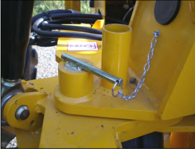
Slew Locked - altijd voor transport & opslag
