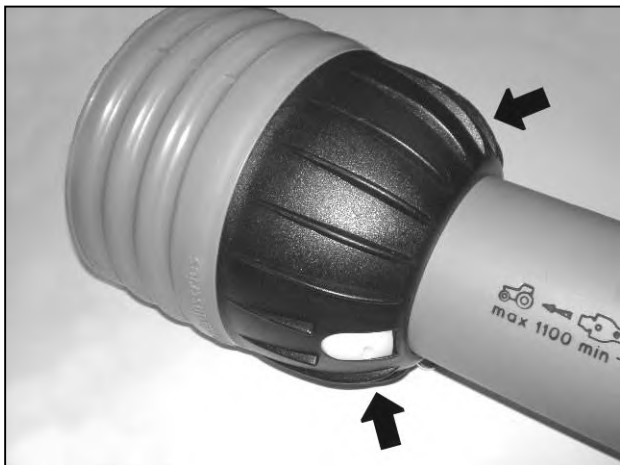
Stezaljke za pričvršćivanje oklopa
