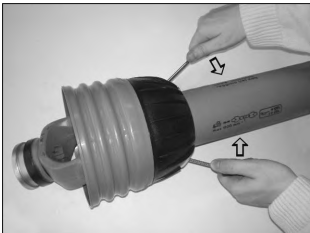
Otvorite stezaljke kako biste otpustili oklop.
