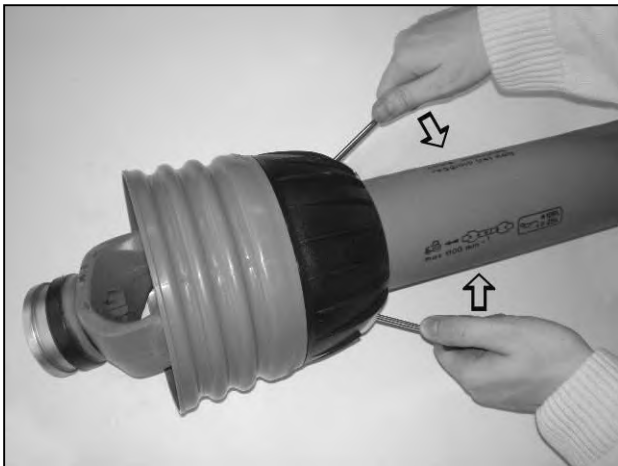
Otvorite stezaljke kako biste otpustili oklop.
