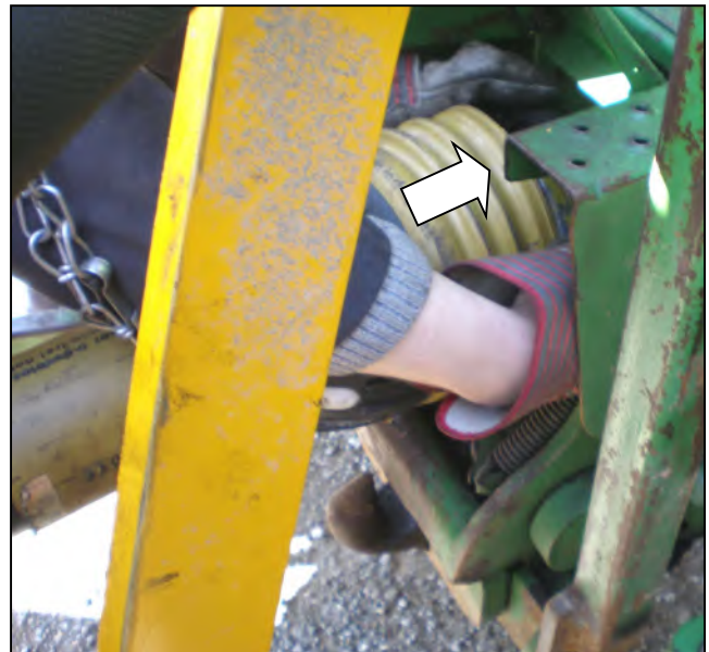
Pričvrstite zglobno vratilo na izlazno vratilo traktora.
