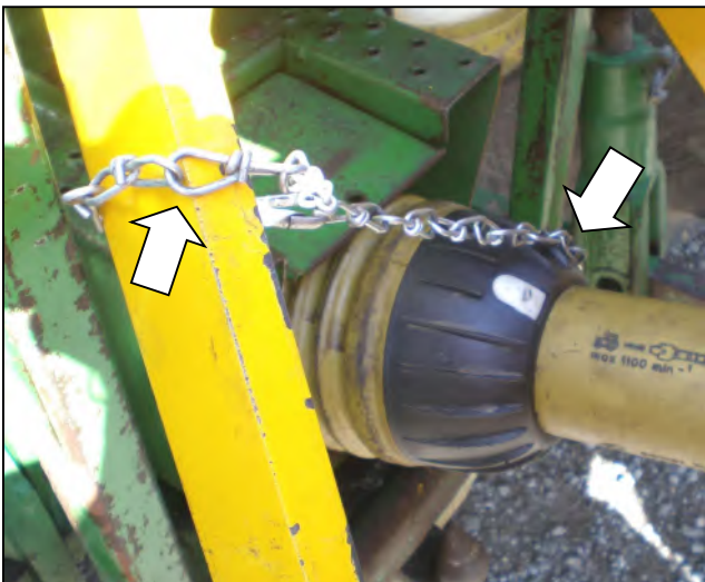
Pričvrstite zakretne lance na prikladna mjesta kako biste spriječili rotaciju zaštite zglobnog vratila.
