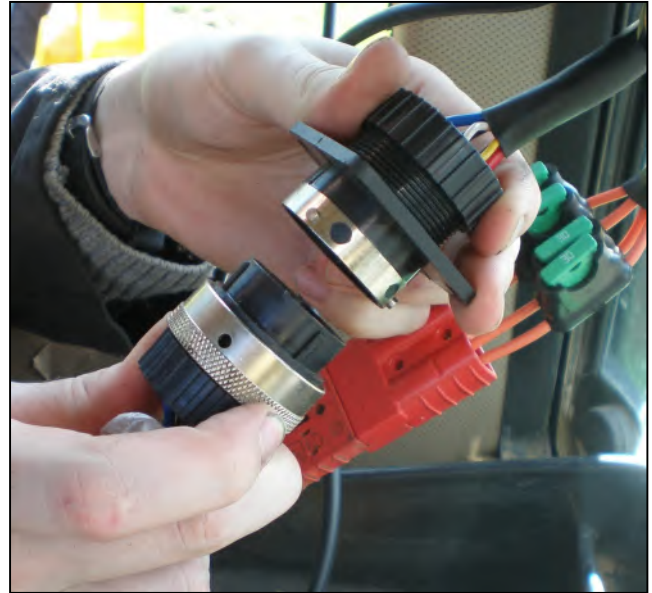
Spojite upravljačke vodove na upravljačku jedinicu strojeva u kabini traktora.
