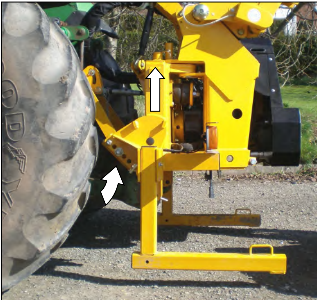
Pritegnite stabilizatore traktora - podignite polugu traktora da biste podigli stroj na radnu visinu.
