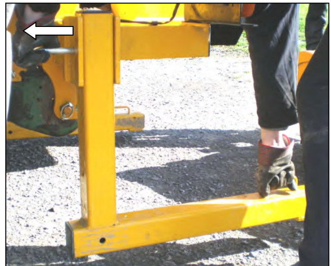
Uklonite potporne noge s obje strane stroja.
