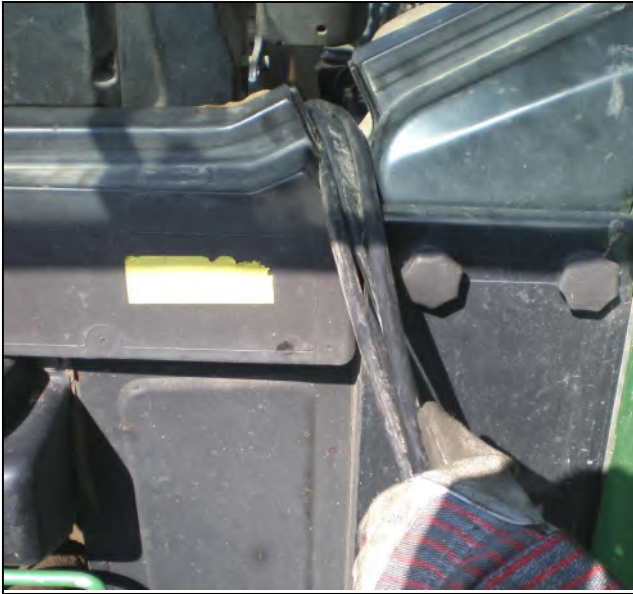
Povlecite krmilne vode v traktorsko kabino – pri tem jih ne zvijajte premočno in jih ne speljite preblizu premičnih delov na stroju ali traktorju.
