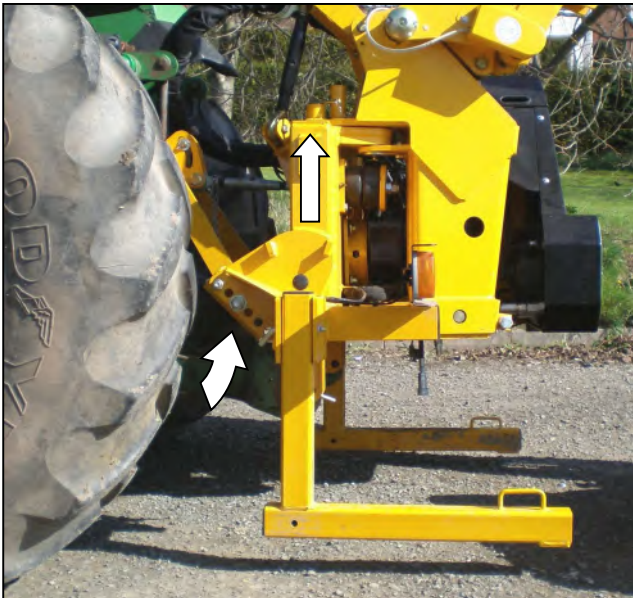
Privijte stabilizatorje traktorja – dvignite traktorski priklop in s tem stroj na delovno višino.
