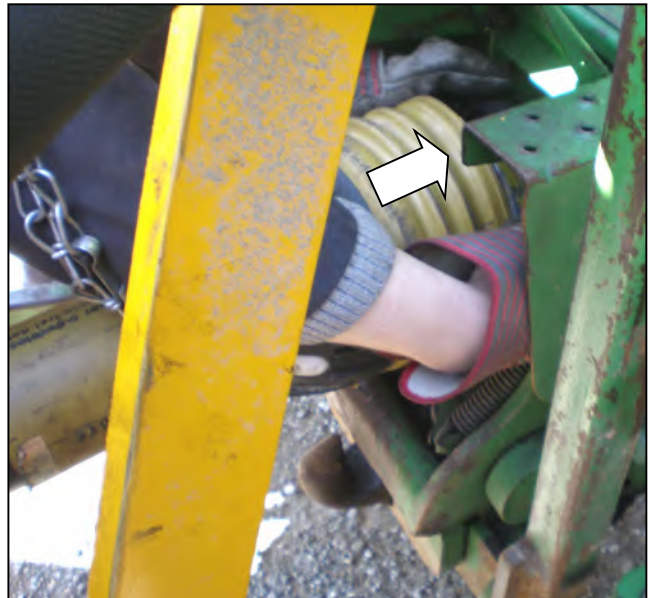
Namestite kardansko gred na izhodno gred traktorja.
