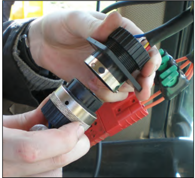
Priključite krmilne vode na upravljalno enoto stroja v kabini traktorja.
