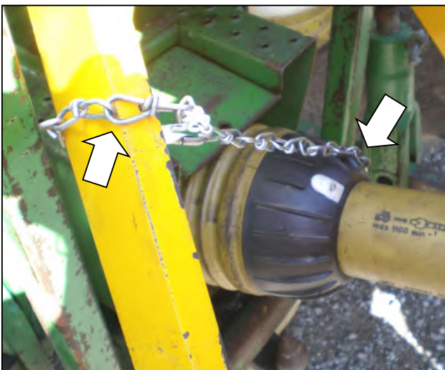
Verige za prenašanje navora namestite na ustrezno mesto, da preprečite vrtenje varovala gredi.
