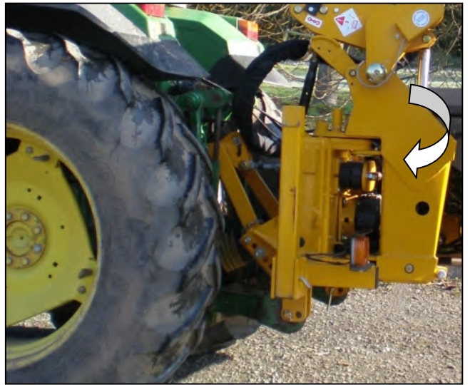
Öffnen Sie den Hubkolbenhahn – schwenken Sie die Maschine auf die Arbeitsseite des Traktors
