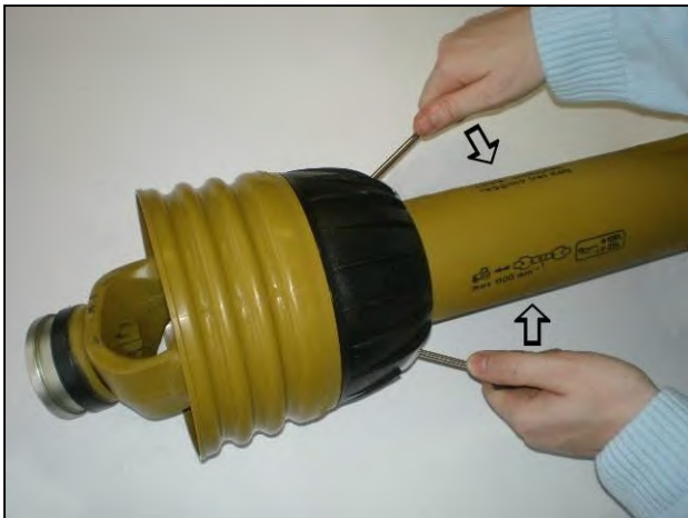
Klappen hochwuchten um den Schutz zu lösen
