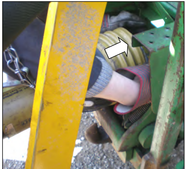
Bevestig aftakas aan de uitgaande as van de trekker.
