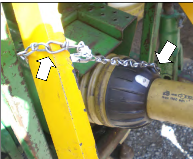
Bevestig koppel kettingen om geschikte locaties om de rotatie van de aftakas bewaking voorkomen.
