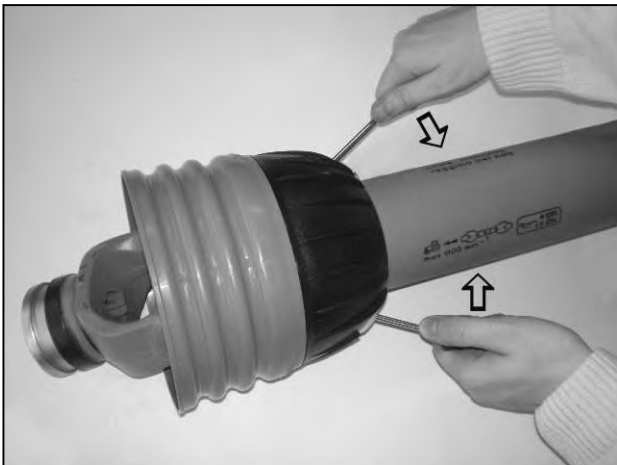
Ouvrez les fermoirs pour dégager la protection
