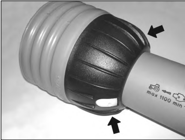
Fermoirs de la protection d'axe
