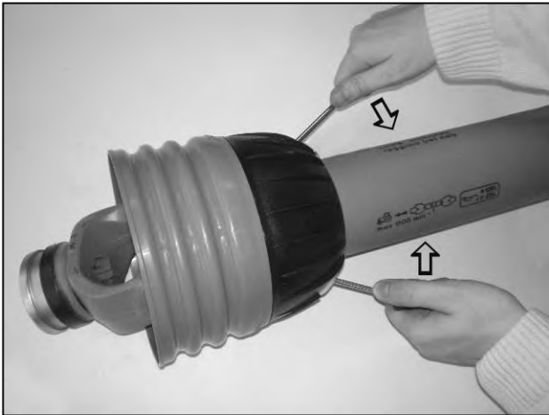
Otvorite stezaljke kako biste otpustili oklop.
