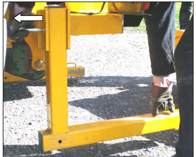
Ta bort stativbenen från maskinens båda sidor.
