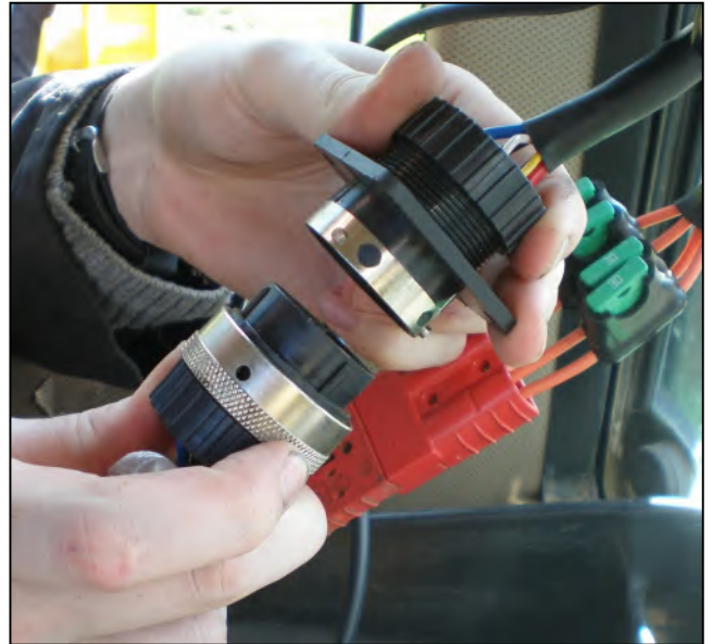
Anslut styrledningar till maskinens styrenhet i traktorhytten.
