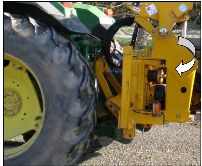
Öppna lyftcylinders låskran - vrid maskinen åt sidan av traktorn i arbetsläge.
