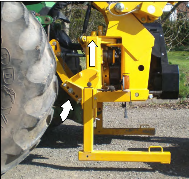
Dra åt traktorns stabilisatorer - höj traktorlänken för att lyfta maskinen till arbetshöjd.
