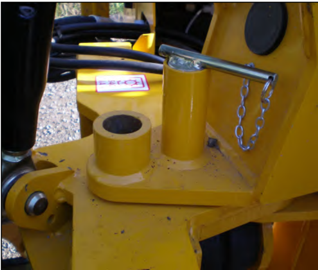
Ta bort och förvara den sväng låssprinten (arbetsläge).
