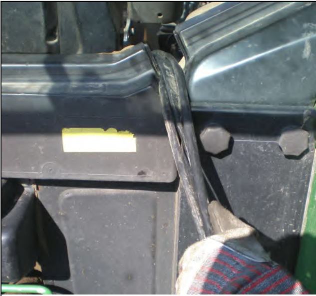
Installera styrledningar i traktorhytten – undvik skarpa kurvor och håll ledningar fria från alla rörliga delar på maskinen eller traktorn.
