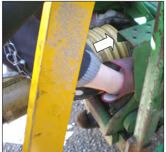
Fäst kraftöverföringsaxeln på traktorns utgående axel.
