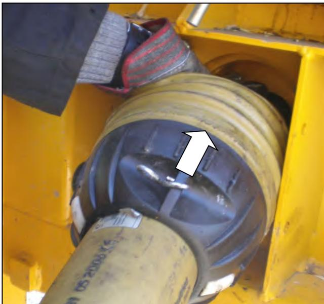
Montare l'albero cardanico sull'asse del riduttore della macchina - NOTA: per l'installazione iniziale di una nuova macchina o dell'attrezzatura su un trattore diverso fare riferimento alla nota della PTO in cima alla pagina.
