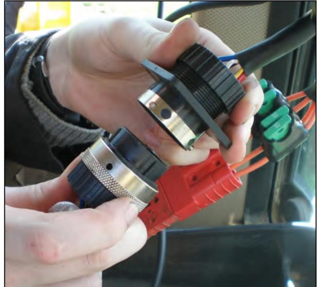
Collegare le linee di controllo all'unità di controllo della macchina nella cabina del trattore.
