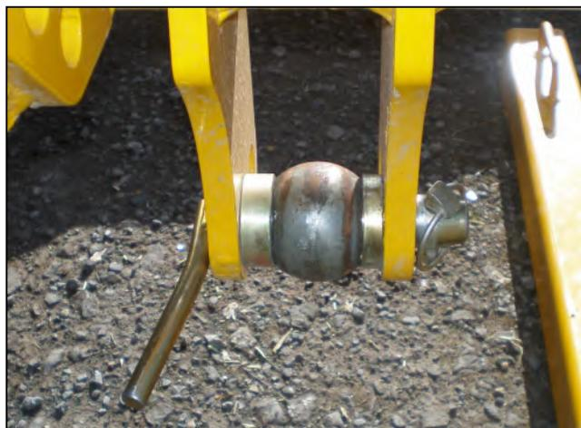
Montare le sfere di collegamento inferiore e i distanziali nei punti di collegamento del telaio inferiore e fissarli con i perni di bloccaggio e di bloccaggio - posizionare i distanziali per posizionare le sfere di collegamento inferiori per un migliore allineamento con i bracci inferiori del trattore.
