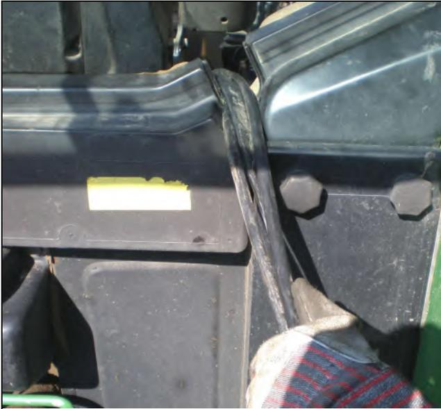
Alimentare le linee di controllo nella cabina del trattore - evitare pieghe brusche e mantenere le linee ben al di fuori di tutte le parti mobili sulla macchina o sul trattore.
