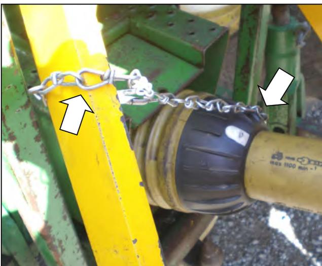
Attaccare le catene di torsione in posizioni convenienti per impedire la rotazione della protezione dell'albero cardanico.
