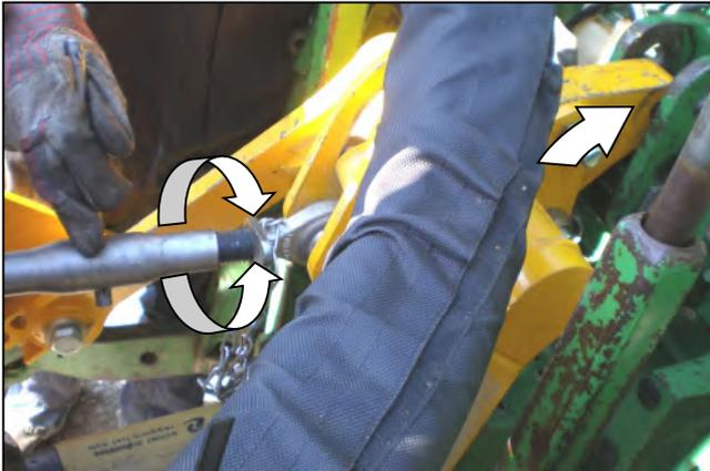
Regolare il collegamento superiore per posizionare la linguetta dello stabilizzatore per il fissaggio alla cerniera superiore del trattore. **NOTA:** sono disponibili linguette alternative per stabilizzatori per diverse applicazioni.
