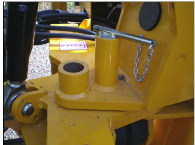
Schwenken entsperrt – nur zum Arbeiten
