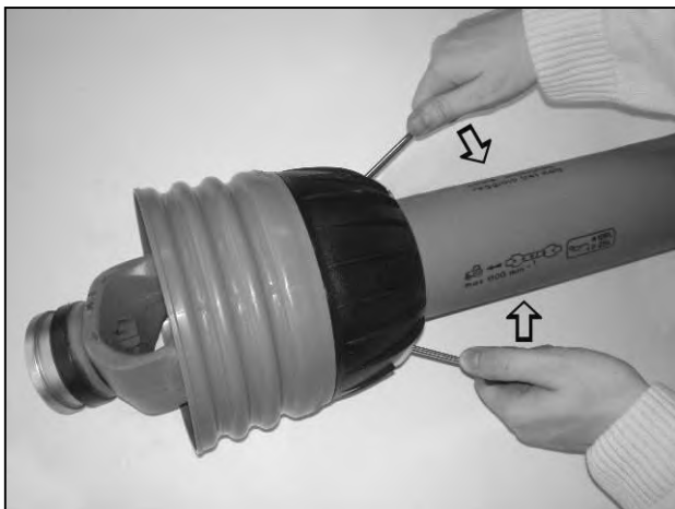
Ouvrez les fermeurs pour dégager la protection
