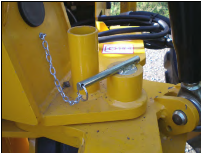
Epingle en position de transport & stockage
