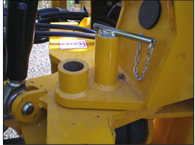
Slew Unlocked - alleen voor het werken
