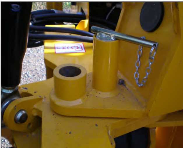
Verwijder en berg de slew borgpen (werk-modus).
