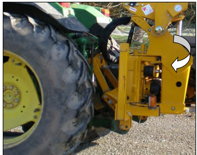
Open lift ram tap - zwenkt de machine aan de kant van de tractor in werkpositie.
