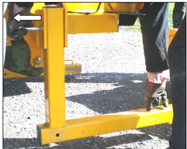
Verwijder steunpoten aan beide zijden van de machine.
