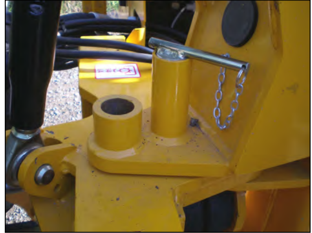
Slew Unlocked - alleen voor het werken
