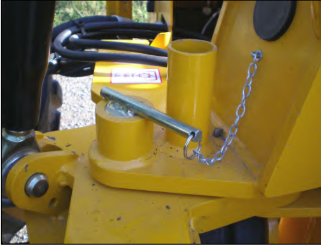
Slew Locked - altijd voor transport & opslag
