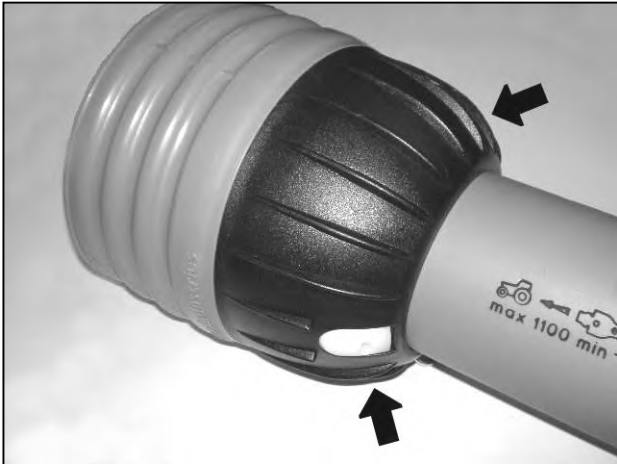
Fermoirs de la protection d'axe
