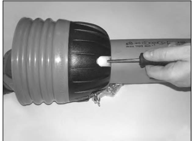
Insérez les tournevis dans les fermoirs
