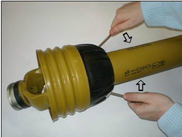
S pritiskom spon sprostite varovalo.
