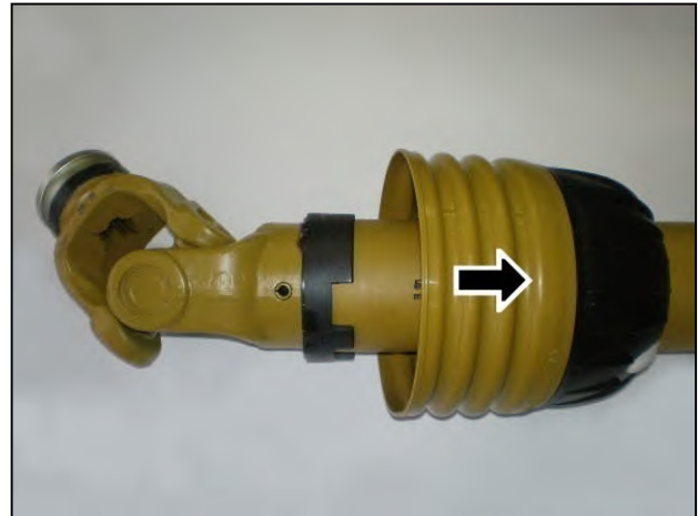
Varovalo potisnite nazaj do univerzalnega zgloba.
