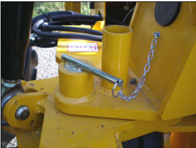
Schwenken gesperrt – immer für Transport und Lagerung
