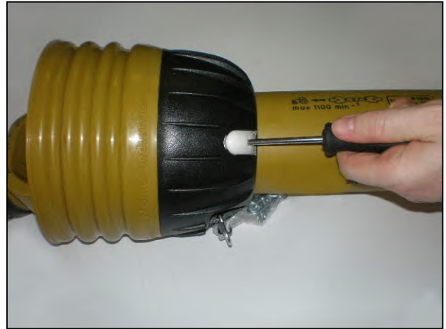
Schieben Sie Schraubenzieher in die Klappen
