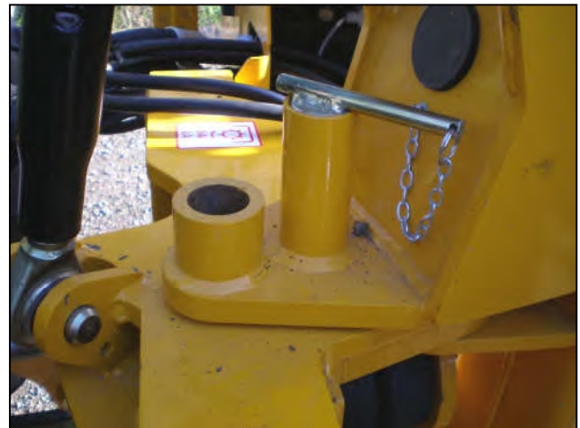
Schwenken entsperrt – nur zum Arbeiten
