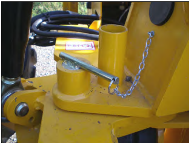
Schwenken gesperrt – immer für Transport und Lagerung
