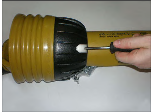
Schieben Sie Schraubenzieher in die Klappen
