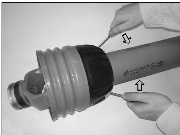
Ouvrez les fermoirs pour dégager la protection
