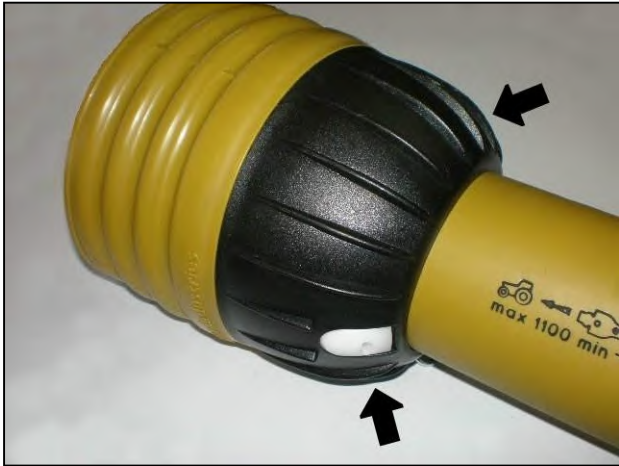
Gleitlagerring des Schutzes
