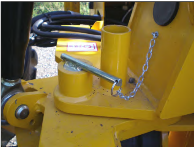
Schwenken gesperrt – immer für Transport und Lagerung
