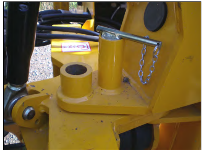
Schwenken entsperrt – nur zum Arbeiten
