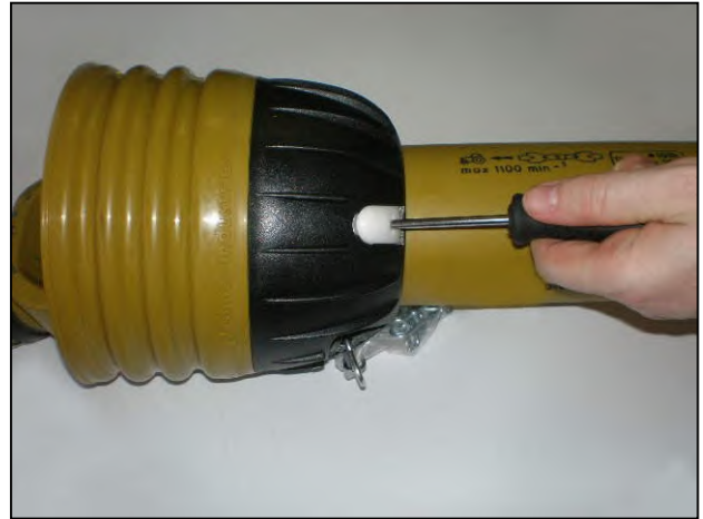
Schieben Sie Schraubenzieher in die Klappen
