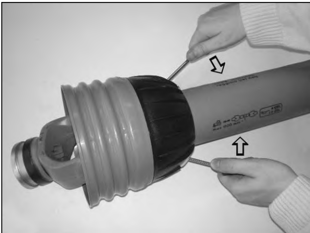
Ouvrez les fermeurs pour dégager la protection
