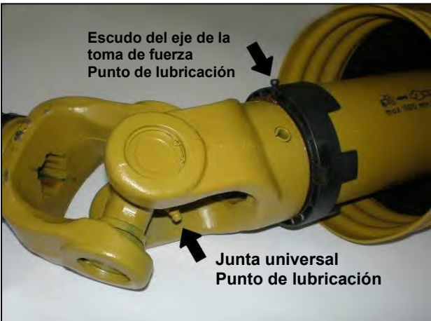
Ubicación de los puntos de lubricación
