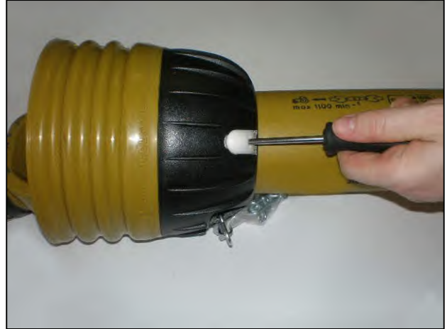
Inserte los destornilladores en los cierres
