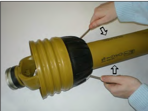
Haciendo palanca los cierres se abren para liberar el escudo
