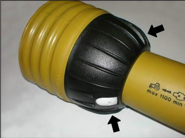
Cierres de fijación del escudo del eje
