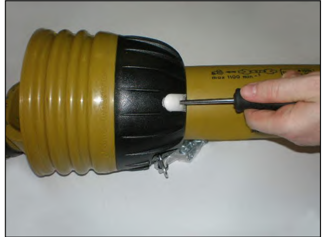
Schieben Sie Schraubenzieher in die Klappen
