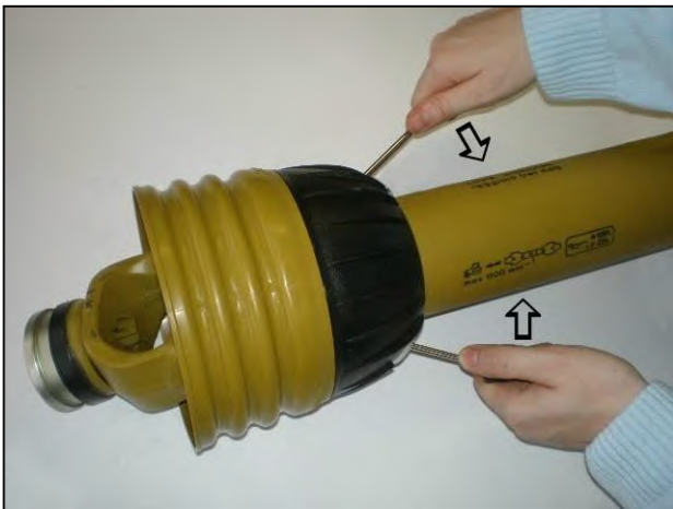
Klappen hochwuchten um den Schutz zu lösen
