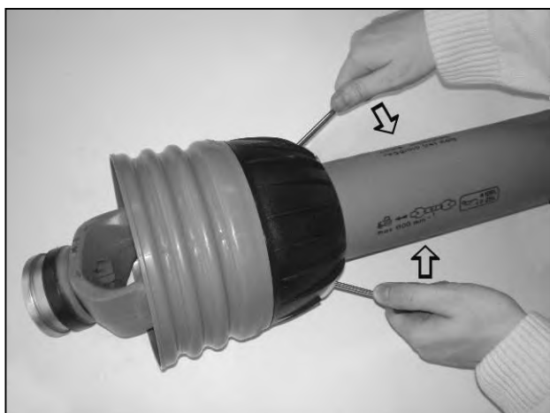
Ouvrez les fermoirs pour dégager la protection
