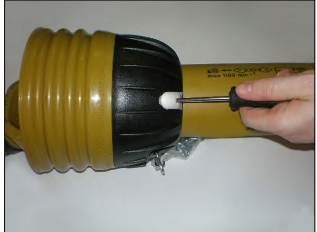
Inserte los destornilladores en los cierres
