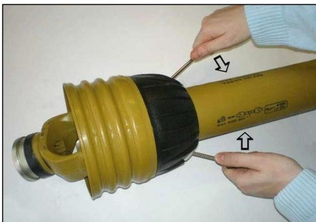
Сместить фиксаторы для снятия кожуха
