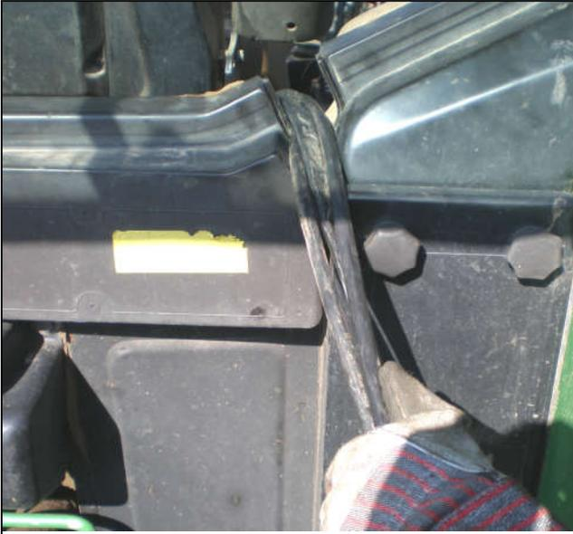
Пропустите контрольные линии в кабину трактора - избегайте резких поворотов и держите линии вдали от всех движущихся частей машины или трактора.
