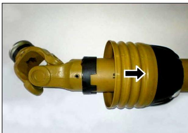
Сдвинуть кожух назад для открывания карданного соединения
