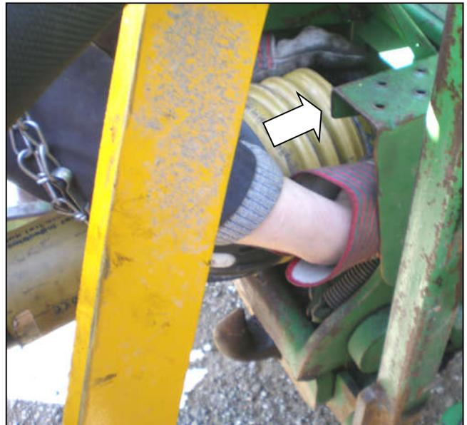
Присоедините вал отбора мощности к выходному валу трактора.
