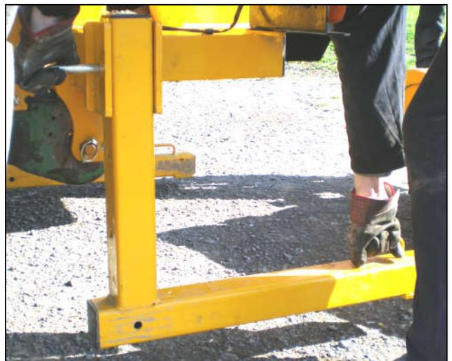
Снимите ножки с обеих сторон машины.
