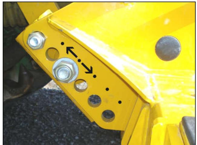
**ВАЖНО:** Задняя часть язычка стабилизатора должна быть как можно ближе к нижней части прорези стабилизатора, когда машина стоит на земле - при необходимости измените нижние точки крепления стабилизатора и / или положение крепления скобы для достижения этой настройки. Это жизненно важно требование для обеспечения того, чтобы язычок находился в средней точке пазов, когда машина поднимается в рабочее положение, что позволяет поплавок в каждом направлении.
