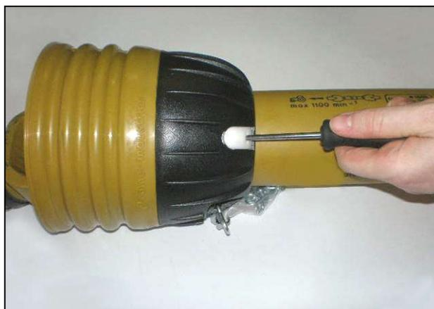
Вставить отвертки в фиксаторы
