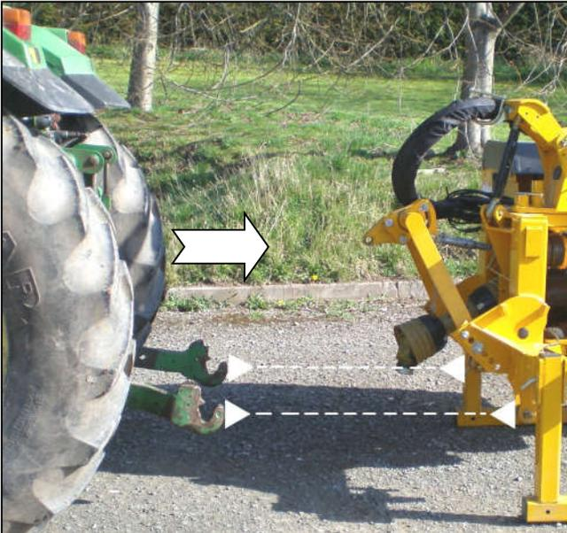
Поверните трактор прямо и по центру к машине - установите нижние тяги трактора на такую высоту, которая позволит устанавливать их на нижние точки крепления рамы.
