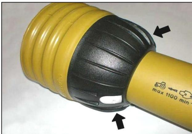
Фиксаторы кожуха вала
