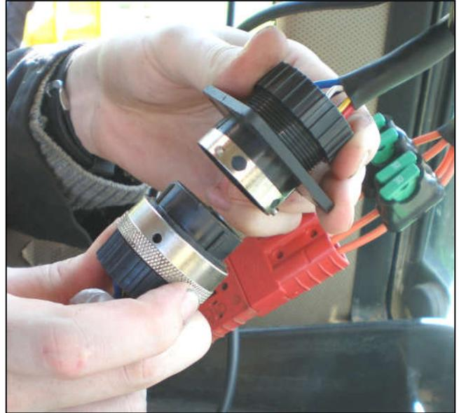
Подсоедините линии управления к блоку управления машины в кабине трактора.
