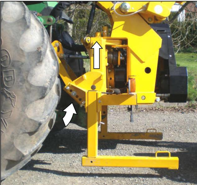
Затяните стабилизаторы трактора - поднимите тягу трактора, чтобы поднять машину на рабочую высоту.
